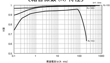
(負荷抵抗と貫通電流から (K) を読み取り出力電圧が計算できます。)
